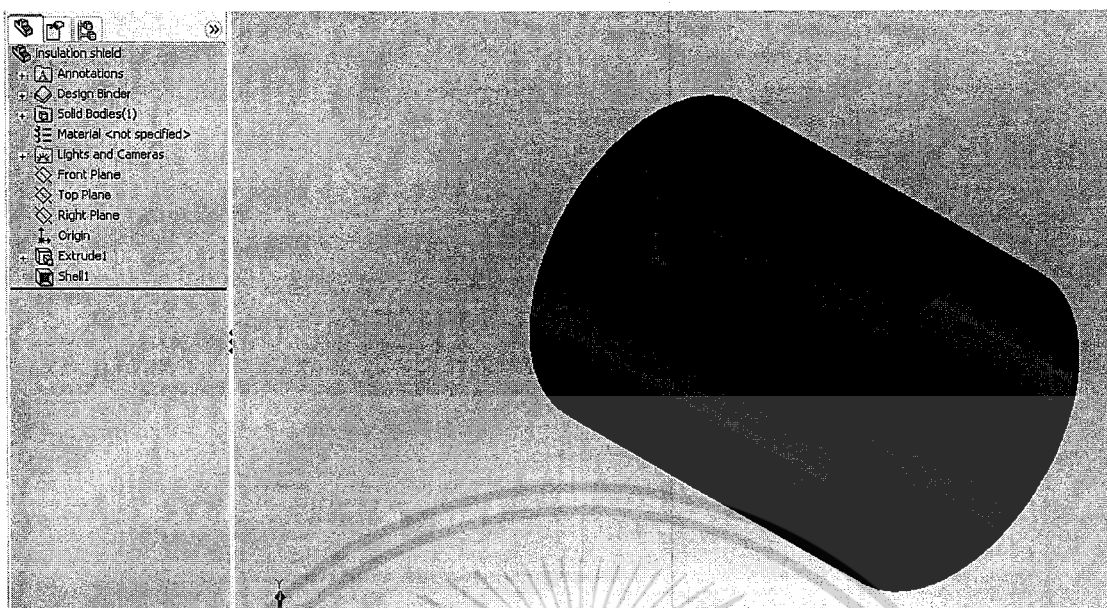
ภาพที่ ก.15 Insulation Screen ที่มีรัศมีภายนอก 36.5 mm. หน้า 1.5 mm. ยาว 80 mm.
