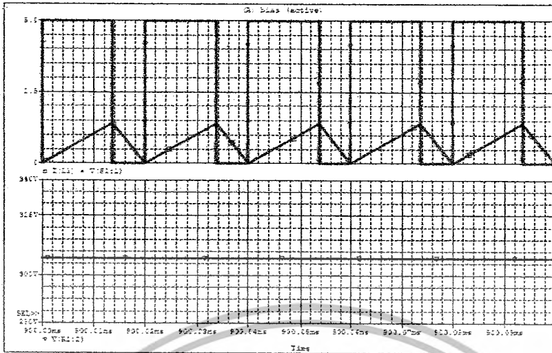
รูปที่ 3.15 แสดงผลการรูปคลื่นสัญญาณควบคุมเปรียบเทียบกับกระแสที่ตัวเหนี่ยวนำ และสัญญาณแรงดันขาออกที่ Duty ratio 0.68
