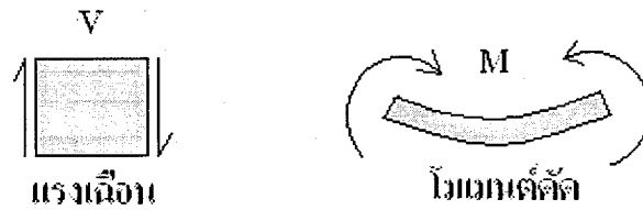
รูปที่ 2.8 ภาพแรงเฉือนและโมเมนต์ดัดที่กระทำต่อคาน
