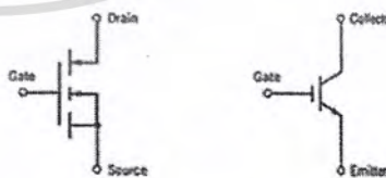
(ค) สัญลักษณ์ของ IGBT ชนิด N-Channel
