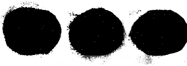
ภาพที่ ข.7 ลักษณะสํารองผงที่ได้จากทดลองที่ T = 60\text{ }^{\circ}\text{C}, v = 4\text{ m/s} (ซ้าย) T = 60\text{ }^{\circ}\text{C}, v = 5 (กลาง) และ T = 60\text{ }^{\circ}\text{C}, v = 6\text{ m/s} (ขวา)
