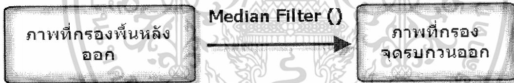
รูปที่ 3.9 แผนผังการกรองจุดรบกวนด้วยวิธีหาค่ากลาง
