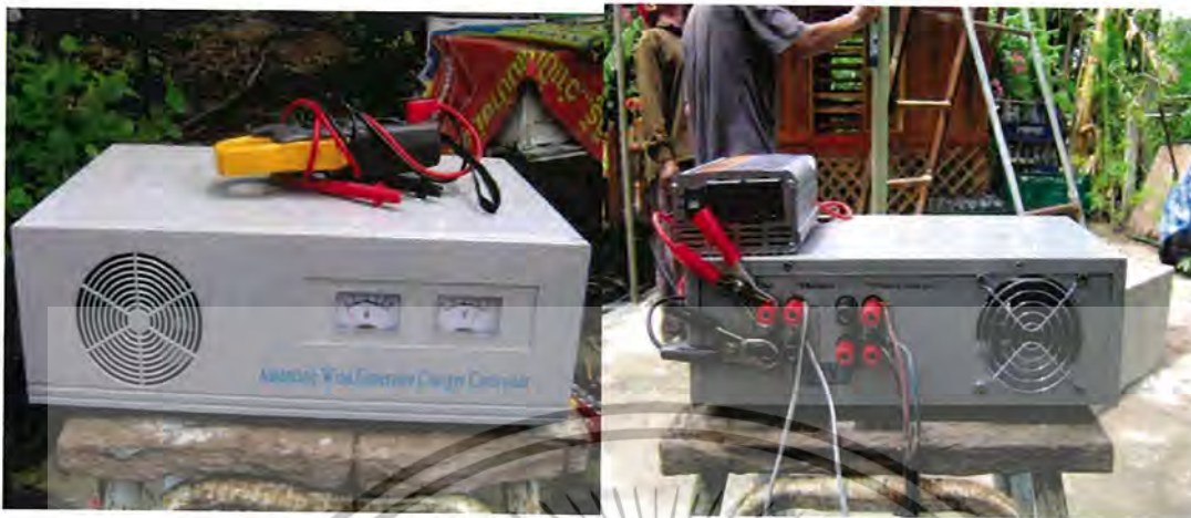
รูปที่ 5.3 แสดงชุดคอนโทรลเลอร์สำหรับกังหันลมผลิตไฟฟ้า [5]
