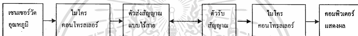
รูปที่ 2.1 บล็อกไดอะแกรมของระบบติดตามผลและส่งข้อมูล
