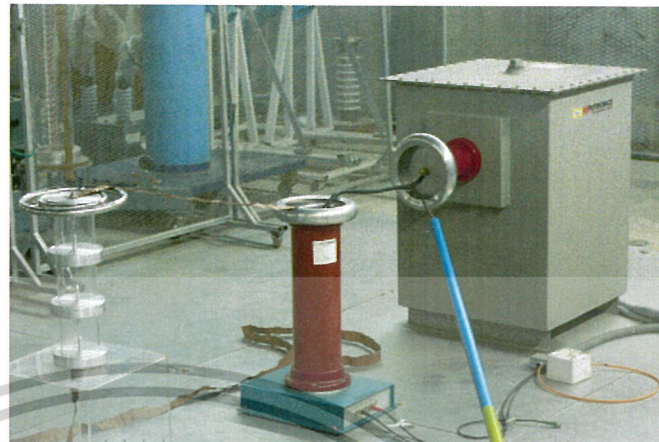
รูปที่ 4.75 การทดสอบ PD ท่อ 3 ชั้นยาว 30cm มี Corona Shield บน
