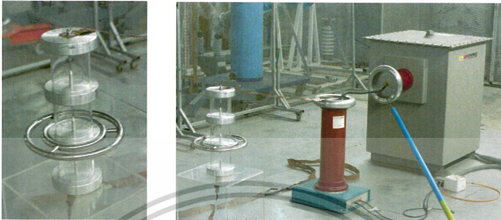
รูปที่ 4.81 การทดสอบ PD ท่อ 3 ชั้นยาว 30cm มี Corona Shield ล่าง
