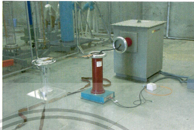
รูปที่ 4.63 การทดสอบ PD ท่อ1ชั้นยาว 30cm มี Corona Shield
