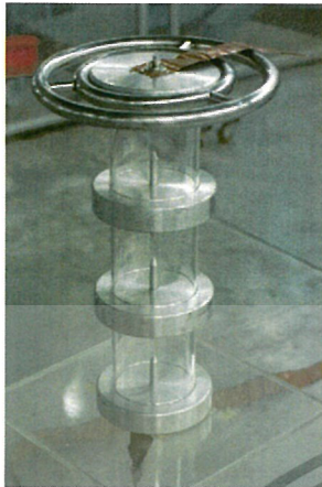
รูปที่ 4.75 การทดสอบ PD ท่อ 3 ชั้นยาว 30cm มี Corona Shield บน
