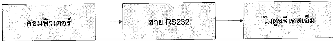
รูปที่ 3.16 ส่วนการเชื่อมต่อโมดูลจีเอสเอ็มเข้ากับคอมพิวเตอร์
