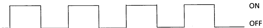
รูปที่ 2.20 สัญญาณพัลส์วidthมอดูเลชั่นมีความกว้างพัลส์เท่ากับ 50 เปอร์เซ็นต์
