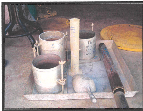
รูปที่ 3-8 ชุดเครื่องมือการทดสอบ Compaction Test
