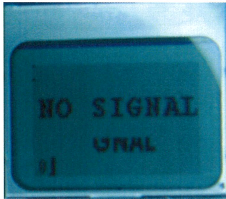
รูปที่ 3.46 รูปภาพที่เกิดจากการผิดพลาดในการส่งข้อมูล ระหว่าง PSoC กับ LCD NOKIA 5110
