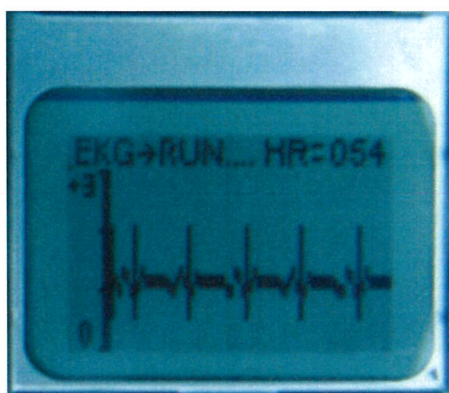
รูปที่ 3.43 รูปภาพที่เกิดจากการวัดจาก ECG SIMULATOR ที่ BPM = 60
