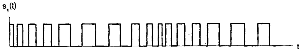
(ข) สัญญาณพัลส์ที่มีคาบความยาวตามการตัดผ่านจุดศูนย์
