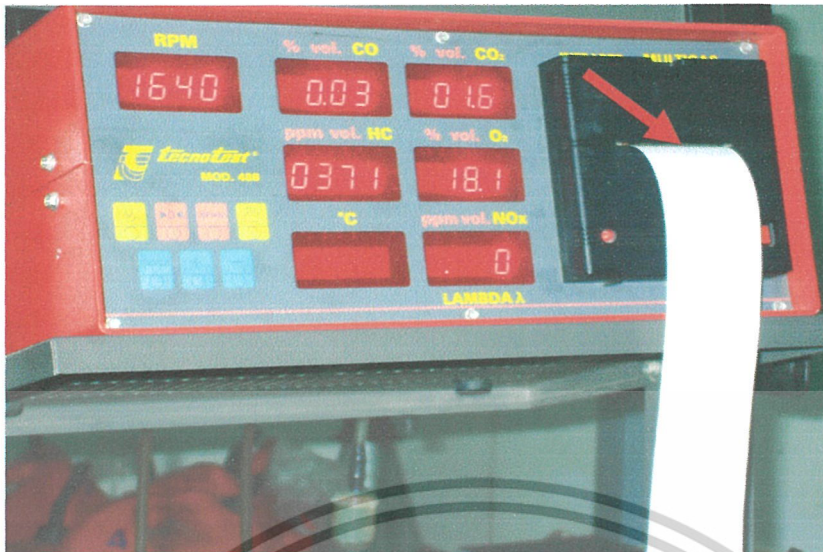
รูปที่ 3.24 หน้าจอเครื่องทดสอบประสิทธิภาพไอเสีย
