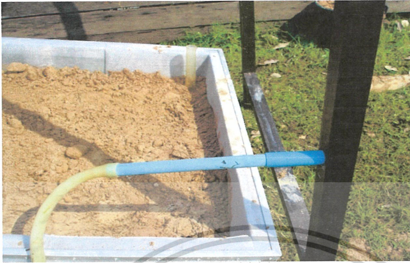
รูปที่ 4.11 แสดงการต่อสายยางเข้ากับชุดทดสอบ
