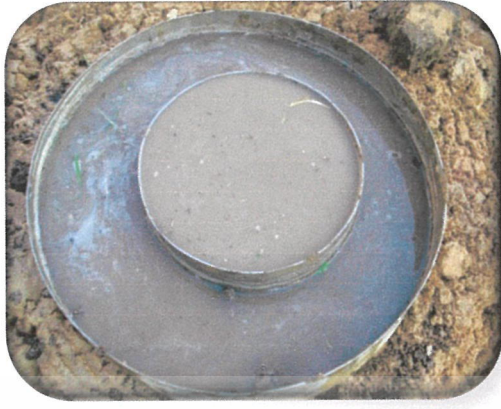
รูปที่ 4.5 เครื่องมือวัดอัตราการซึมของน้ำผ่านผิวดินหลังเติมน้ำ
