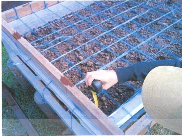
รูปที่ 4.21 การนำ Mesh Box และตลับเมตรวัดหน้าดินที่เหลือ
