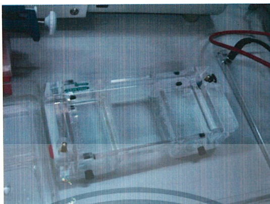
รูปที่ 3.15 เครื่อง Electrophoresis Mini SUB™ DNA Cell ที่เทสารละลาย Electrophoresis buffer (1xTAE) แล้ว
