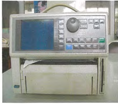
รูป 3.10) เครื่องบันทึกสัญญาณ ยี่ห้อ YOKOGAWA รุ่น OR 1400
