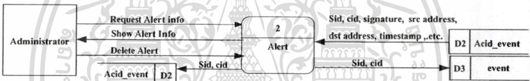
รูปที่ 3.4 แสดง Dataflow diagram level 1 ของ Alert
