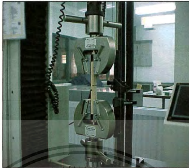
รูปที่ 3.6 วิธีทดสอบความแข็งแรงดึงแบบเฉือนด้วยเครื่องทดสอบอเนกประสงค์
