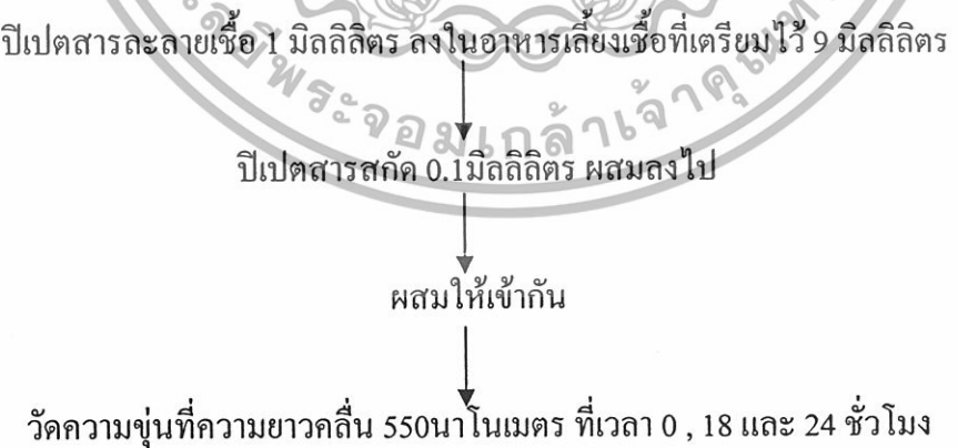
รูปที่ 3.3 ขั้นตอนการทดสอบฤทธิ์ในการยับยั้งการเจริญของเชื้อจุลินทรีย์โดยวิธี Agar diffusion
