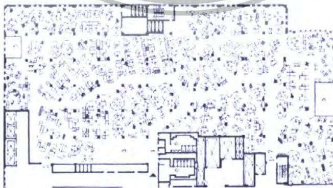
ภาพที่ 2.21 แสดงตัวอย่างการจัดผังสำนักงานแบบ Landscape Office
