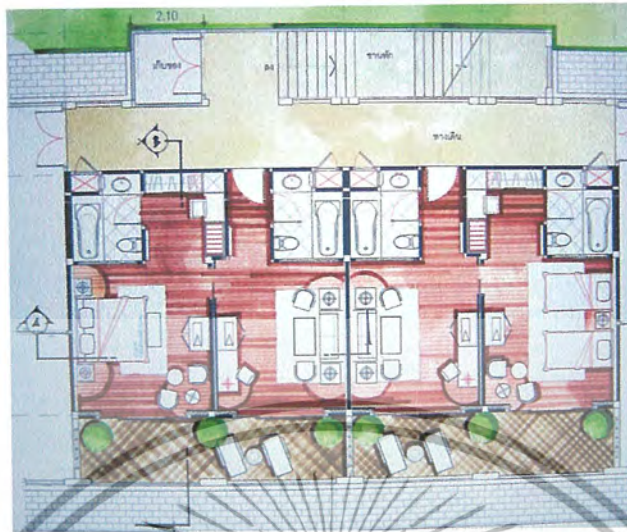
ภาพที่ 5.68 แสดงการจัดวางผังเฟอร์นิเจอร์และผังพื้นในส่วนห้องพักแบบ Deluxe room
