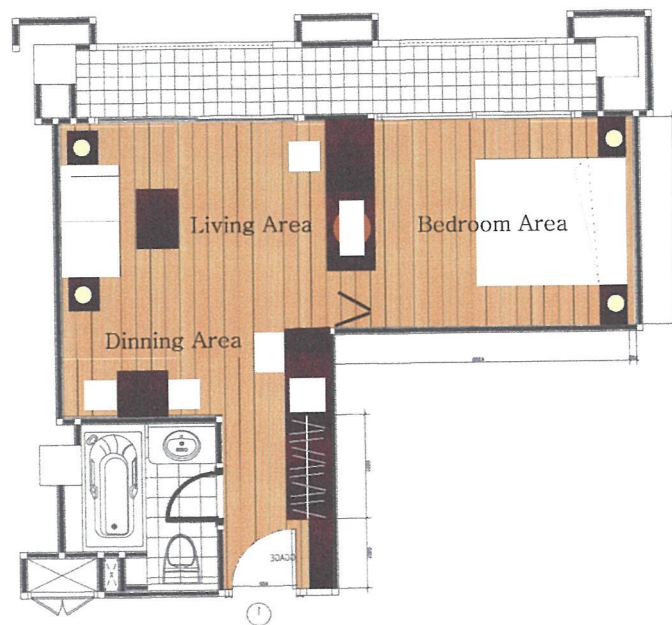
ภาพที่ 5.66 แสดงแปลนเฟอร์นิเจอร์และแปลนพื้นที่ส่วนส่วนห้องพักแบบ JUNIOR SUITE ROOM
