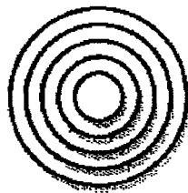
ภาพประกอบที่ 2.51 แสดงหน้ากากการกระจายลมแบบวงกลม
