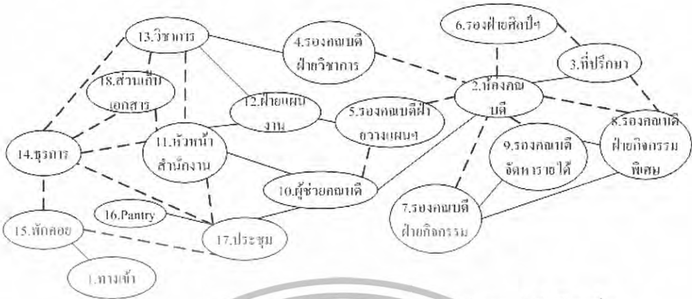
แผนภูมิที่ 4.15 แสดงค่าความสัมพันธ์แบบฟองอากาศส่วนภายในสำนักงาน
