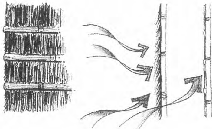
ภาพที่ 4.90 แสดงรายละเอียดผนังบ้านชาวทะเลลักษณะผนังบ้านชาวทะเลที่นิยมใช้ใบจากยึดติด ไม้ไผ่ตามแนวขวางปิดทับ เพื่อป้องกันการหลุดร่วงจากกระแสลมทะเลที่แรง
