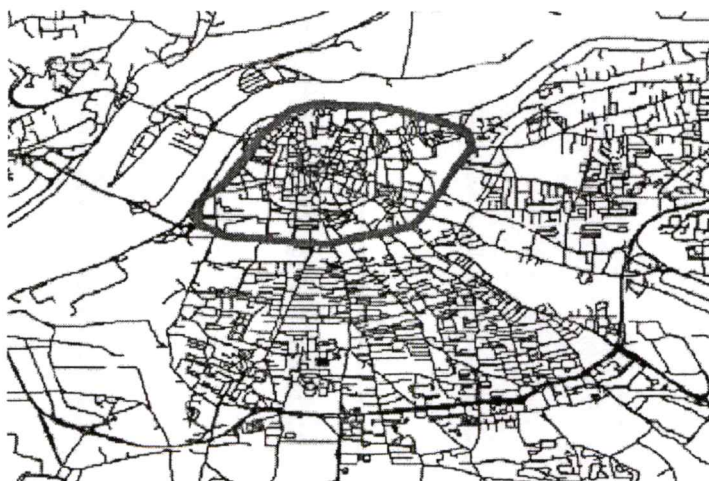
รูปที่ 2.16 โครงสร้างแบบริงในโครงข่ายถนน
