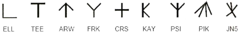
รูปที่ 2.12 รูปร่างทางแยกที่จำแนกตามคี่กริชของโหนด [13]
