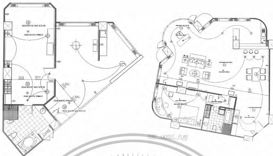
ภาพที่ 5.60 แสดงการจัดวางผังฟ้าเพดานและระบบไฟฟ้าในส่วนห้องพักแบบ SUITE ROOM
