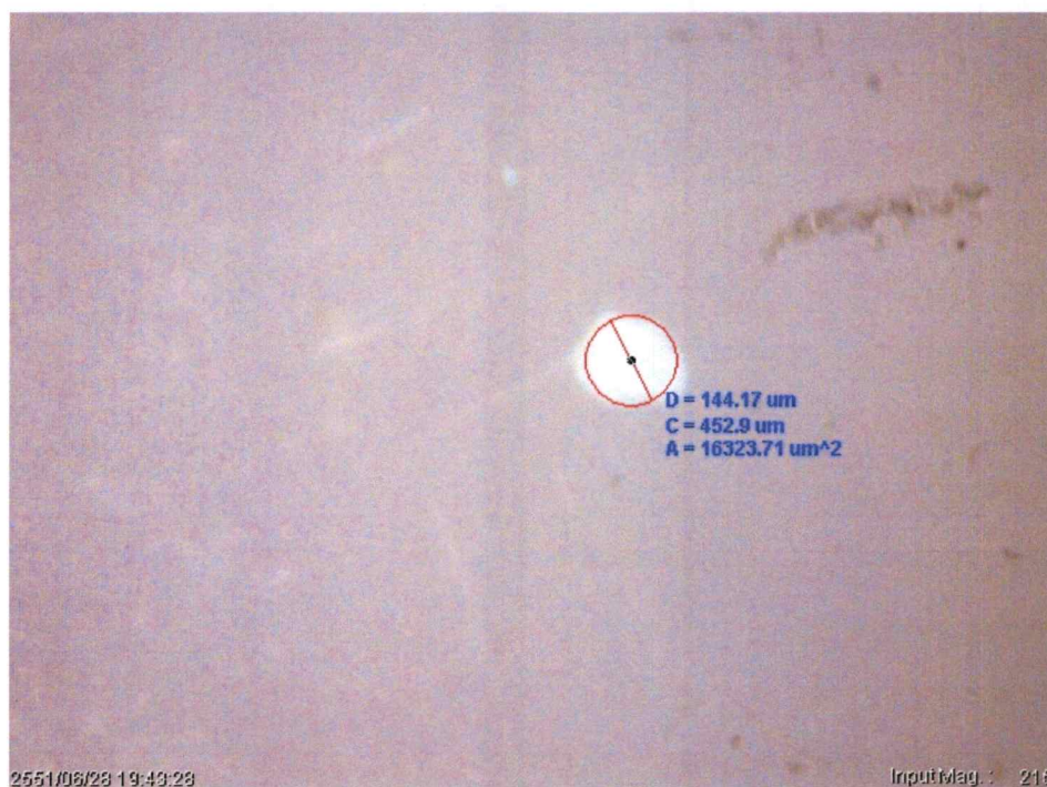
รูปที่ 3.16 แสดงภาพแป้ง Calamine มาตรฐานที่ใช้ในการวัดใช้กล้องจุลทรรศน์ไมโครสโคปในการวัด (โดยในภาพแป้งเกาะกลุ่มใหญ่)
