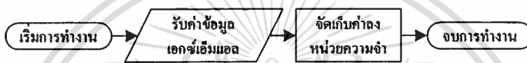
รูปที่ ข 1 ขั้นตอนการทำงานของส่วนรับข้อมูลเข้า
