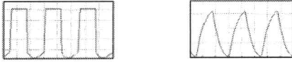
(ค) โหลด L_1 สเกล: 100V/div; 20A/div; 20µsec/div รูปที่ 7 ผลการจำลองการทำงาน ที่คัตวี่แฟคเตอร์ 0.5
