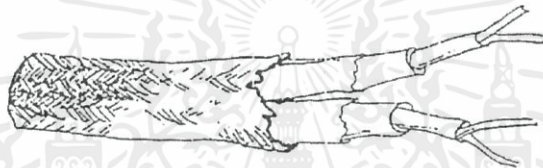
รูปที่ 2.41 ภาพสายไฟสำหรับอุปกรณ์ประเภทให้ความร้อนสูง
