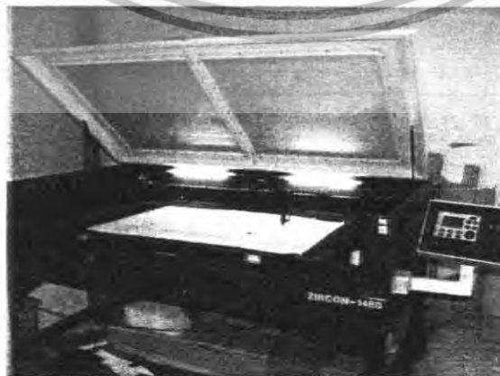
ภาพที่ 60 แสดง การวางผ้าบนเครื่องตัดเลเซอร์
