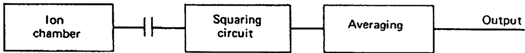
รูปที่ 3.5 บล็อกการทำงานของโหมดค่าเฉลี่ยกำลังสองของแรงดัน
