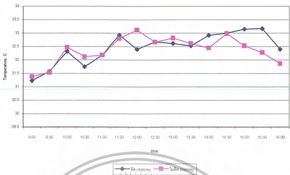
รูปที่ 4-27 แสดงการเปรียบเทียบอุณหภูมิภายในบ้านด้านบน กรณีเปิดทางเข้าและทางออกทั้งหมด
