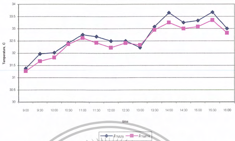
รูปที่ 4-17 แสดงการเปรียบเทียบอุณหภูมิด้านบนกับด้านล่างของห้องที่ติดปล่องรังสีอาทิตย์ กรณีเปิดทางเข้าทั้งหมดและปิดทางออก
