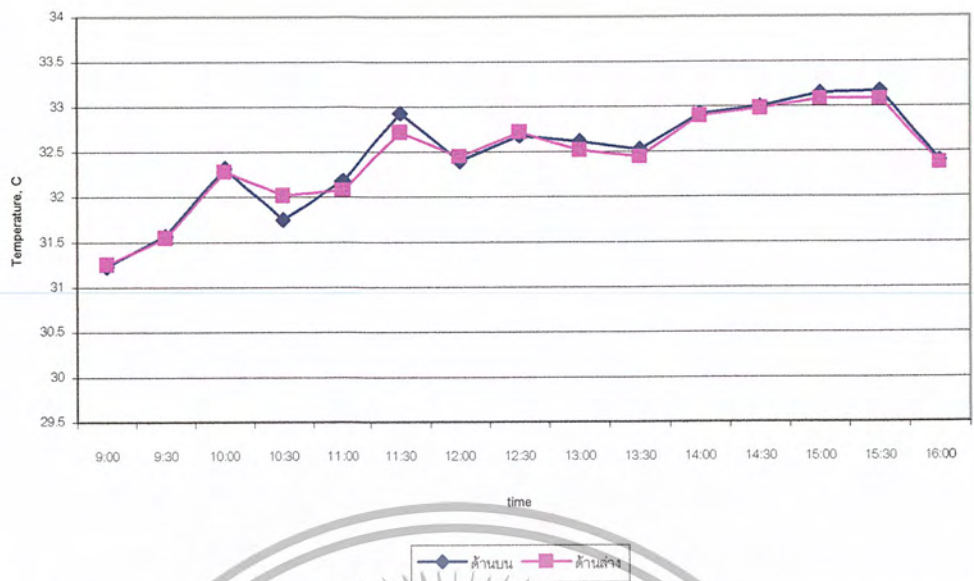
รูปที่ 4-29 แสดงการเปรียบเทียบอุณหภูมิด้านบนกับด้านล่างของห้องที่ติดปล่องรังสีอาทิตย์ กรณีเปิดทางเข้าและทางออกทั้งหมด
