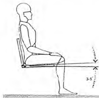
ภาพที่ 2.26 แสดงลักษณะความลาดเอียงของเบาะนั่ง
