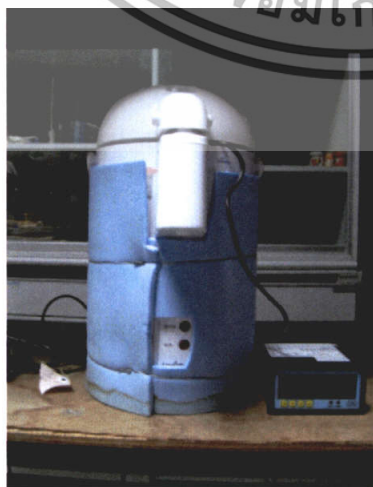
ภาพที่ 11 ลักษณะของกระติกน้ำร้อนอัตโนมัติขนาดเล็กที่หุ้มด้วยโฟมยัดหยุ่น ให้นำไปใช้ประโยชน์ด้านการค้า ไม่ว่ากรณีใดๆทั้งสิ้น อีกทั้งห้ามมิให้ตัดแปลงเนื้อหา และต้องอ้างอิงถึงเจ้าของเอกสารทุกครั้งที่มีการนำไปใช้
