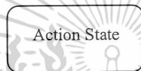
รูปที่ 2.28 สัญลักษณ์สถานะ (Action State)
