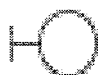
รูปที่ 2.8 สัญลักษณ์แทนคลาสขอบเขต (Boundary Class)
