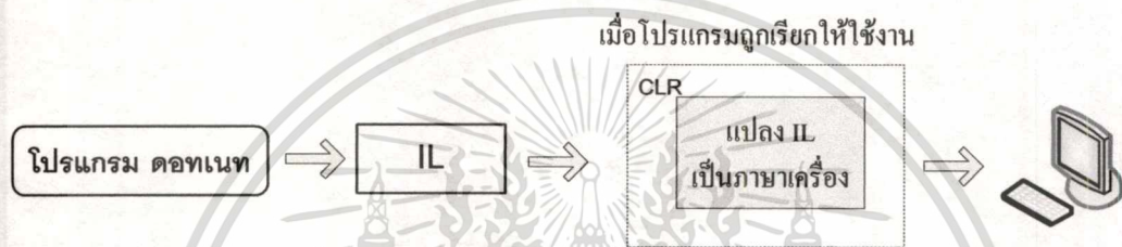
รูปที่ 2.2 รูป CLR แปลง IL ให้เป็น Native Code
