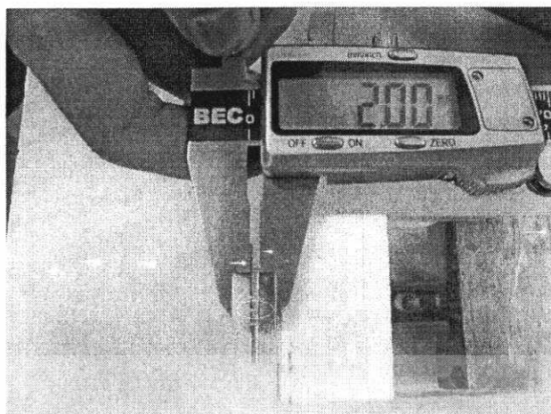
ภาพที่ 4-13 ชิ้นงานที่อยู่ก้ำจัดเศษโลหะที่ค่าปาสเตอร์ 147 ไมโครฟารด์
