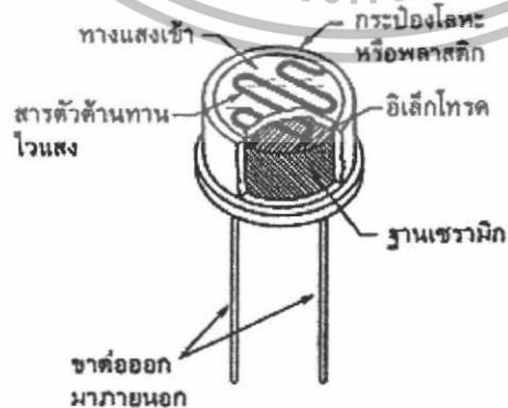
รูปที่ 2.22 โครงสร้างภายในของ LDR
