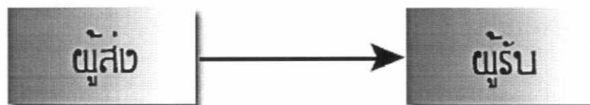
รูปที่ 2.23 แสดงการส่งข้อมูลแบบซิมเพล็กซ์
