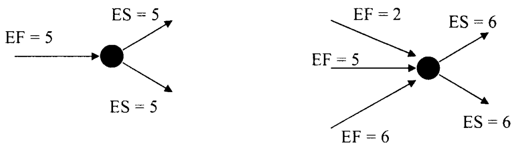
ภาพที่ 2.5 การคำนวณเวลาเริ่มต้นเร็วที่สุด (ES) และเวลาแล้วเสร็จเร็วที่สุด (EF)
