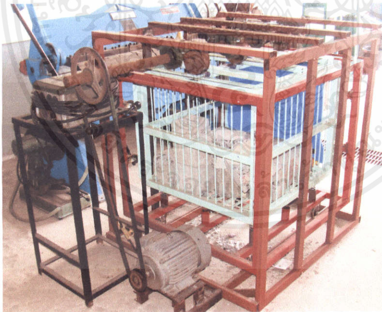
รูปที่ 5.11 ภาพจริงด้านหลังของเครื่องจำลองการเขย่าในหม้อฆ่าเชื้อ
