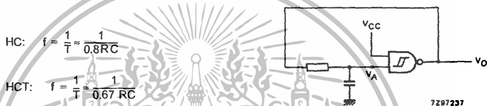
รูปที่ 3.3 แสดงสมการความถี่ ที่สร้างวงจร Oscillator ของ Schmitt Trigger
