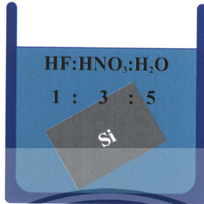
รูปที่ 3.24 การสร้างพอร์สซิลิคอนด้วยวิธีการกัดข้อมสี่
