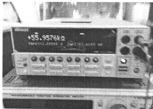
รูปที่ 4.16 ภาพถ่ายเครื่องมือวัดและจ่ายแรงดัน/กระแสไฟฟ้า
