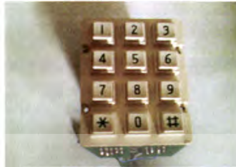
รูปที่ 2.37 คีย์แพด หรือ สวิตช์เมตริก 4x3 จุด
