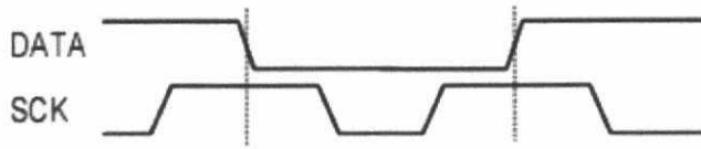
รูปที่ 2.5 แสดง Timing Diagram ในช่วงการส่งข้อมูลของ SHT 15
