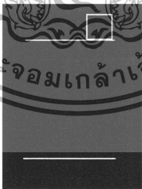
รูปที่ 3.7 แสดงกรอบสี่เหลี่ยมที่ใช้ตรวจหายานพาหนะบนเส้นตรวจจับ
